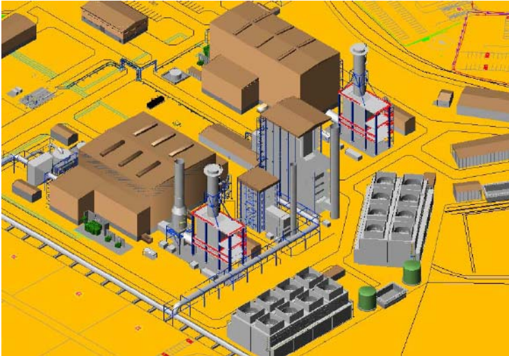
3D- Darstellung Gichtgaskraftwerk Sidmar
